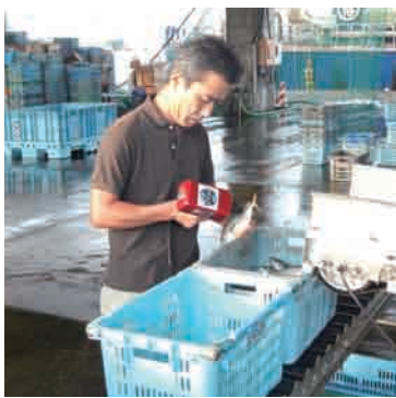
画像提供:浜田市水産物ブランド化戦略会議 「脂質検体機器」を使用し、脂質を測定
